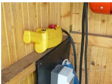
Nach Beendigung des Slippens muss das Steuergerät oben auf das Querholz in der Windenbox gelegt werden und darf keinesfalls am feuchten Boden liegen.
