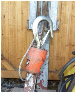
Zur Befestigung am Slipwagen oder Trailer muss der große Karabinerhaken immer direkt an einer Öse des Bootshängers eingehängt werden. Sehr gut eignet sich die Schlaufe, die im Windenkasten bereit liegt.
